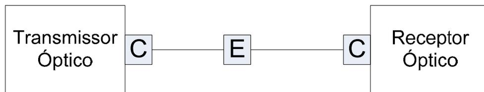
A figura ilustra um enlace óptico no qual C representa um conector e E emenda. A tabela apresenta parâmetros associados à fibra óptica, ao transmissor óptico, ao receptor óptico, às emendas e aos conectores empregados no enlace. Sabendo que se emprega a transmissão ON-OFF NRZ, que a mensagem transmitida possui dígitos binários igualmente prováveis, e que a distância entre o Transmissor e o Receptor é de 54 Km, a Margem de segurança considerada no enlace, em dB, é igual a:
