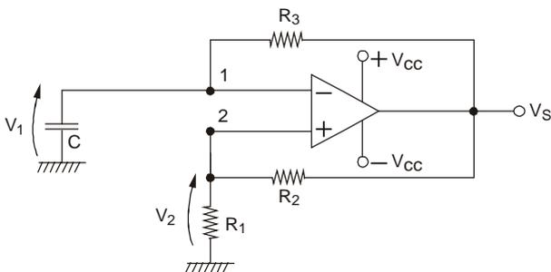
51. O elemento que faz a comparação entre as tensões  $V_1$  e  $V_2$  é um circuito integrado linear denominado
