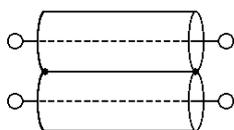
109 A figura a seguir ilustra a seção de um guia de onda normalmente usado para a conexão do transmissor à antena em sistemas MMDS (*multichannel multipoint distribution service*), em que a frequência da portadora de radiofrequência (RF) está na faixa de microondas.
