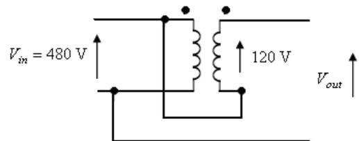
**139** Para o transformador ilustrado na figura a seguir,  $V_{out} = 360 \text{ V}$ .
