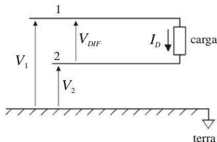
O desempenho dos sistemas de comunicação é limitado pela ocorrência de ruído e interferência. No caso de EMI (*electromagnetic interference*), a maneira mais eficiente de se reduzir esse tipo de interferência é eliminando ou reduzindo a fonte de radiação. Considerando a figura acima, que ilustra uma linha de dois fios terminada por uma carga, julgue os próximos itens, com relação a EMI e a maneiras de reduzir a interferência inserida ou provocada por esses fios em sistemas de comunicação.
