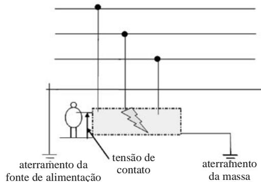
A figura acima ilustra um esquema de aterramento para a proteção de equipamentos de informática, alimentados por um sistema trifásico de 380 / 220 V. Nesse esquema, a resistência de aterramento da fonte de alimentação trifásica é igual a  $10 \Omega$  e a resistência de aterramento da massa é igual a  $20 \Omega$ .
