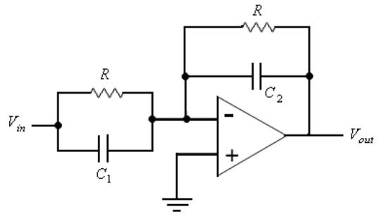
No circuito ilustrado na figura acima, o amplificador operacional é ideal,  $R = 20 \text{ k}\Omega$ ,  $C_1 = 100 \text{ pF}$  e  $C_2 = 0,01 \text{ }\mu\text{F}$ . Com relação a esse circuito, julgue os itens a seguir.
