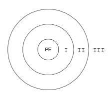
O esquema acima representa um ponto de instalação energizado (PE) e as áreas delimitadas radialmente referentes às regiões de risco, aqui denominadas I, II e III e que significam:
