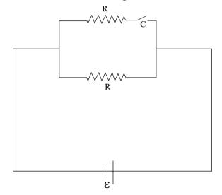
Sabe-se que quando a chave C está aberta, a intensidade da corrente elétrica total que percorre o circuito é i, e a potência nele dissipada é P. Pode-se afirmar que, fechando a chave, os valores da intensidade da corrente e da potência dissipada, no circuito, serão, respectivamente,
