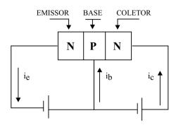
Considere a curva característica tensão-corrente de um transistor no qual a diferença de potencial entre o coletor e o emissor é mantida em 20 V. Se a corrente elétrica de base variar de 0,10 mA para 0,15 mA, o fator de ampliação do
