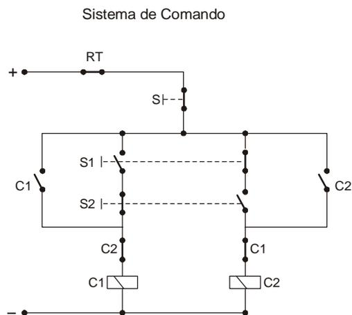
Para acionar o motor em um sentido de rotação e invertê-lo após um intervalo de tempo  $\Delta t$  deve-se
