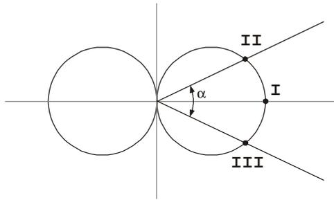
No ponto I, o campo elétrico vale  $E_{máx}$  ou 0 dB e nos pontos II e III ele vale  $0,707.E_{máx}$  ou -3 dB. O parâmetro  $\alpha$  denomina-se
