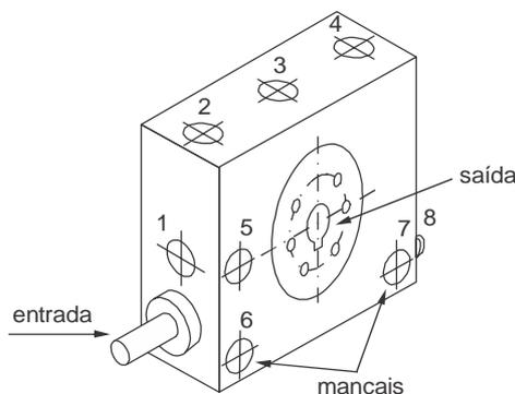
Para a análise de um redutor de rosca sem fim, a partir da coleta de dados de sinais de vibração, é suficiente a colocação dos sensores nas posições
