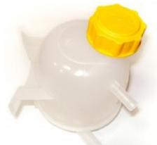
No sistema de arrefecimento, a água, além de ficar em todo o sistema, pode ser encontrada em um reservatório [reservatório de expansão de água] para suprir eventuais perdas por ebulição e garantir o perfeito funcionamento do sistema.
