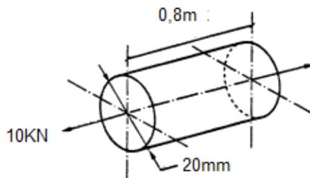
$E_{aço} = 210 \text{ GP}_a$  (módulo de elasticidade do aço)
